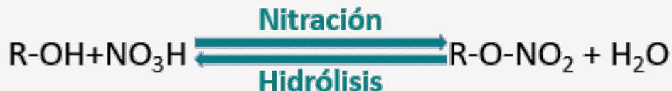
El ácido sulfúrico promueve la hidrólisis del éster, si bien el rendimiento de la hidrólisis no es significativo respecto a la esterificación. Además de estas reacciones, acontecen también otras de oxidación durante el proceso de nitración/esterificación, que no resultan significativas si la nitración de productos orgánicos, tales como el glicerol o la celulosa, se lleva a cabo a baja temperatura, entre 0° y 20°C, con la mezcla de ácidos.
