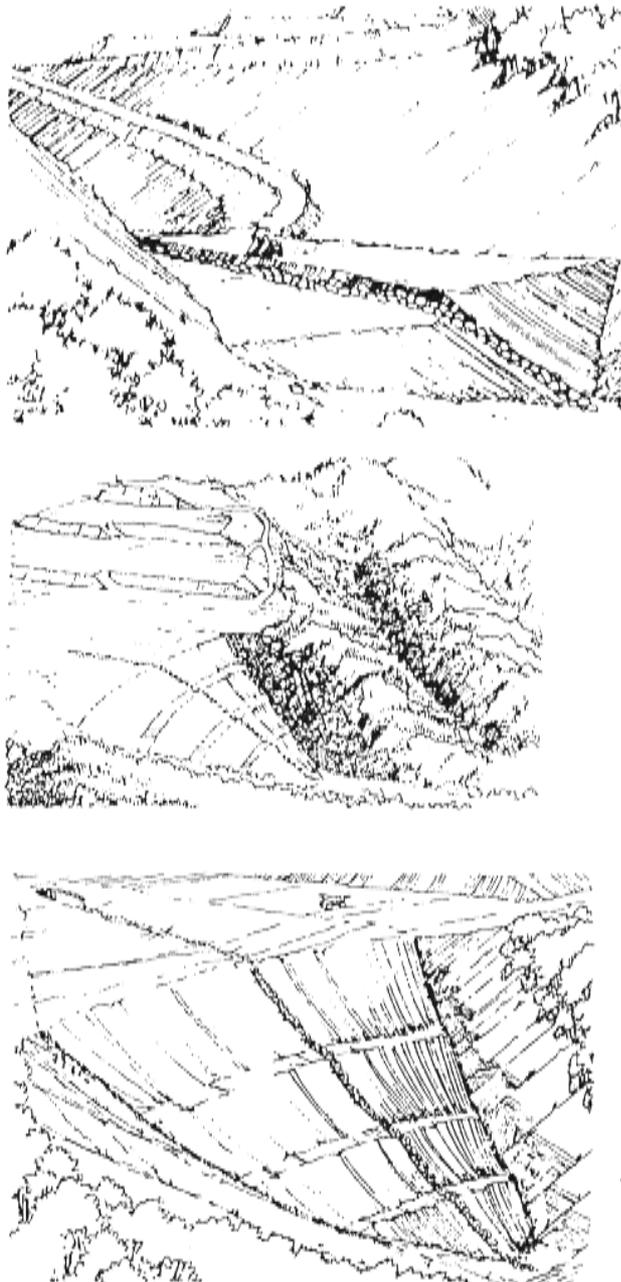
Figura 3.12. Escombrera de vaguada construida por tongadas y con núcleo central de drenaje. (Robins, J. D.)
