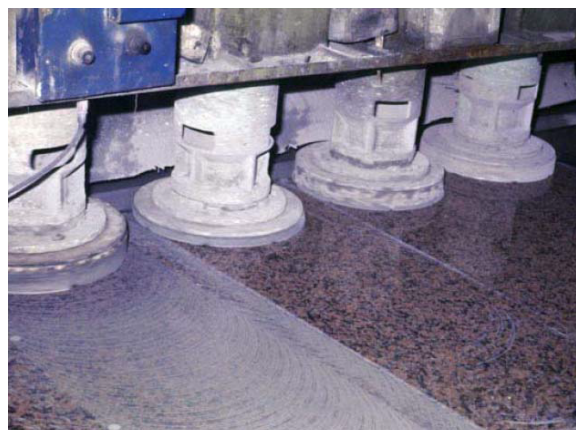
Figura 14.4. Acabado superficial pulido con brillo: se utilizan abrasivos cada vez más finos.
