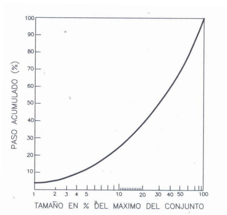
Figura 7.7. Curva granulométrica típica de los productos de las machacadoras de mandíbulas.
