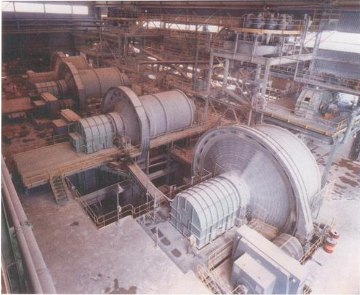
Figura 8.17. Taller de molienda con molinos semiautógenos, en primer plano, y molinos de bolas, trabajando en circuito cerrado con clasificadores de ciclones.
