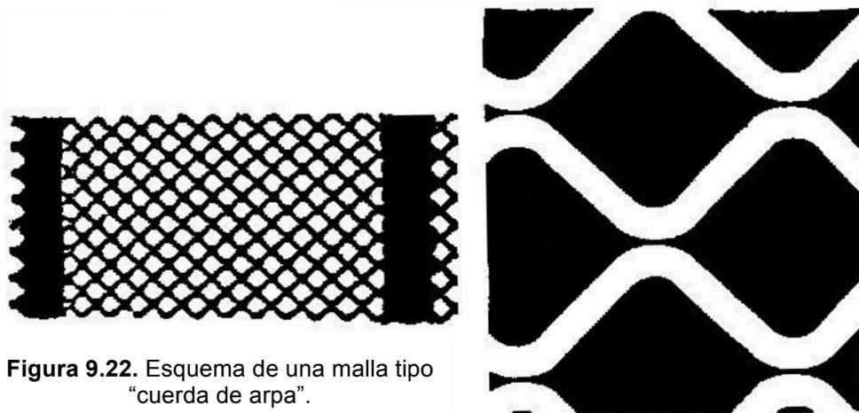
**Figura 9.22.** Esquema de una malla tipo "cuerda de arpa".
