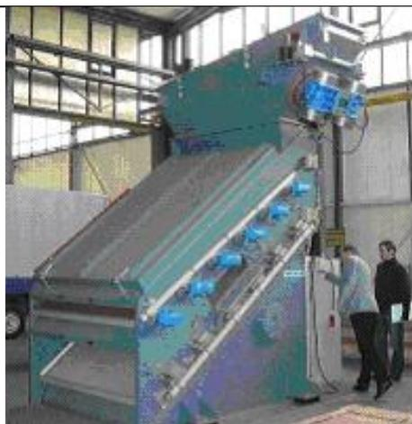
Criba, marca Rhewum, de tamiz vibratorio, agitación directa de las mallas. La estructura es fija. Se puede adaptar estancia 100% al polvo.
