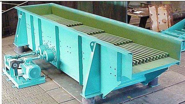
Criba vibratoria de barrotos sobre soportes elásticos de caucho.
