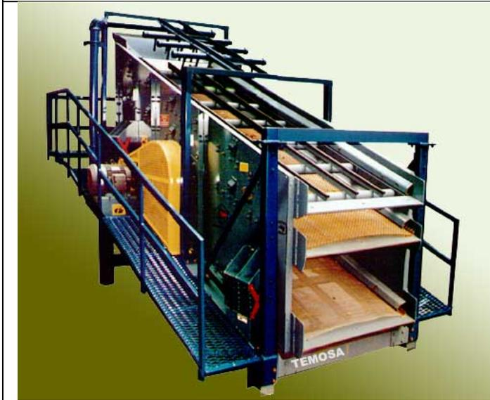
Criba para finos de dos mallas, tres clasificados, y con disposición de riego de agua.
