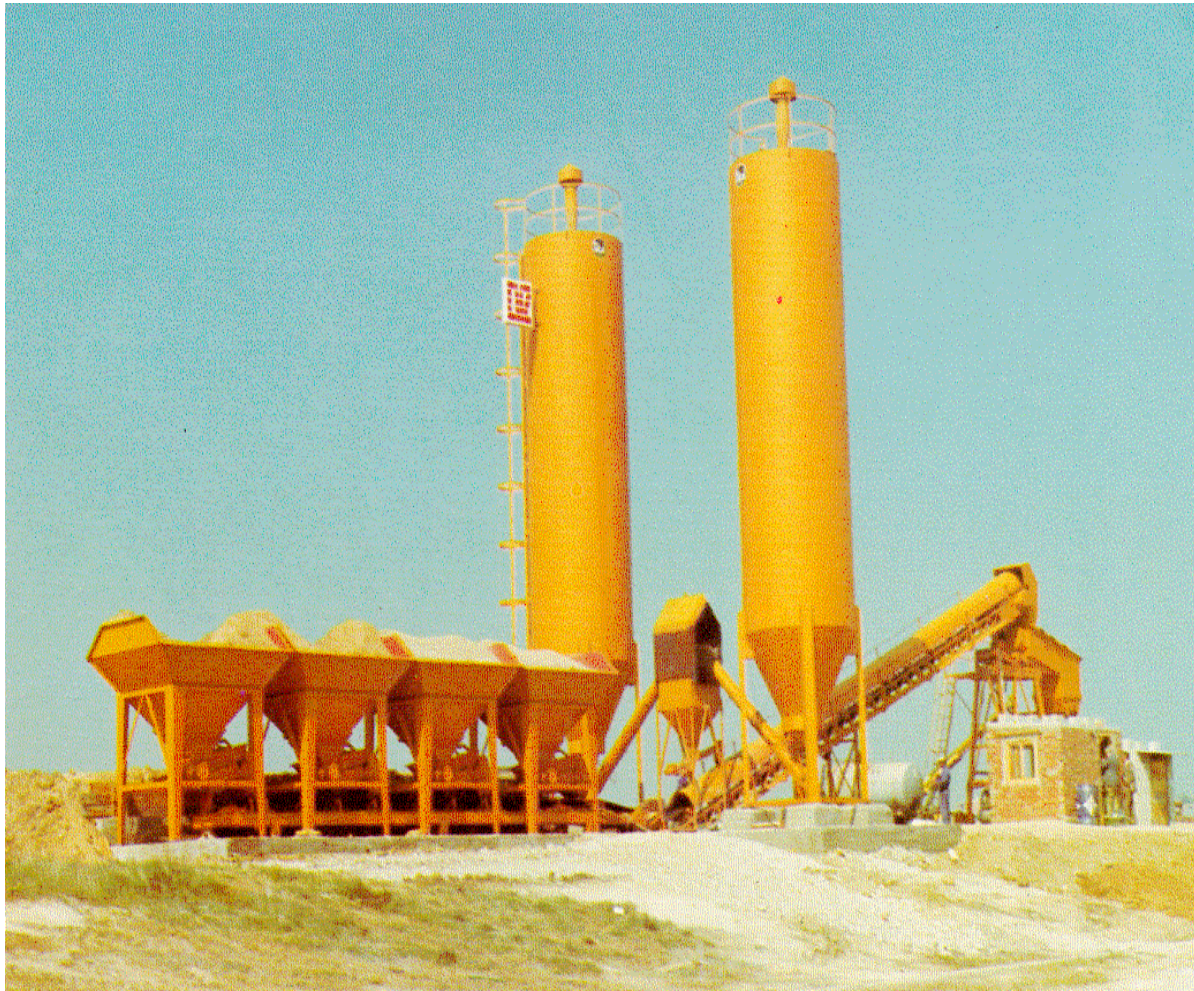
PLANTA FIJA DE GRAVA CEMENTO PARA UNA PRODUCCION DE 250 t/h.
