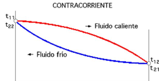
Teóricamente la temperatura de salida de un fluido puede igualar con la de entrada del otro,  $t_{11} = t_{22}$  y/o  $t_{12} = t_{21}$
