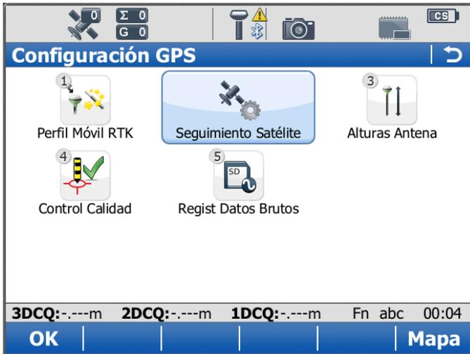
La configuración en esta pantalla define el sistema de satélite, los satélites y las señales de los satélites que utilizará el instrumento.
