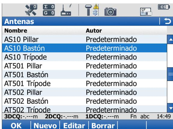
La opción **Atura por Defecto** establece la altura predeterminada de la antena para el tipo de trabajo actual. Esta altura será la altura predeterminada de la antena durante la utilización de las aplicaciones. Se puede modificar mientras se esté realizando un levantamiento pero el valor predeterminado se seguirá manteniendo.
