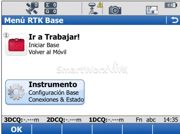
El menú que aparece al configurar el instrumento en ESTÁTICO es el que se indica y la pestaña **Instrumento** permite introducir la **Configuración Base**.
