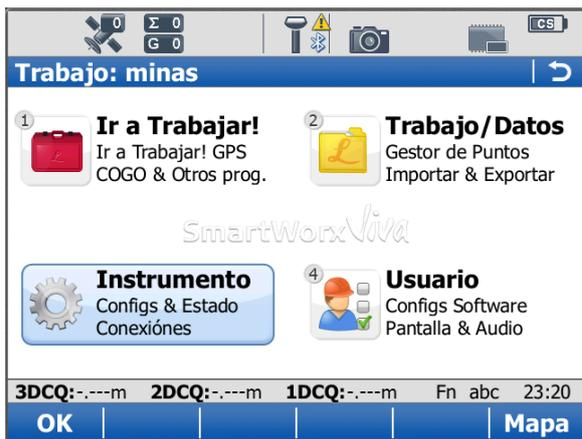
A partir de dicho icono se puede configurar el GPS principalmente para proceder a **Registrar Datos Brutos** (estático) o **Perfil Móvil RTK**.
