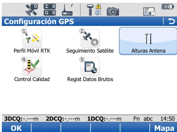
Las antenas de Leica están predeterminadas por defecto y se les puede seleccionar de la lista. Las antenas predeterminadas incluyen una elevación que depende del modelo de corrección.
