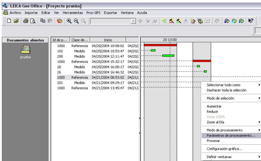
De los diferentes parámetros que se pueden ajustar en dicha ventana merece la pena destacar el **ángulo o máscara de elevación**, que será el límite a partir del cual se incluirán unos satélites u otros para dicho cálculo.
