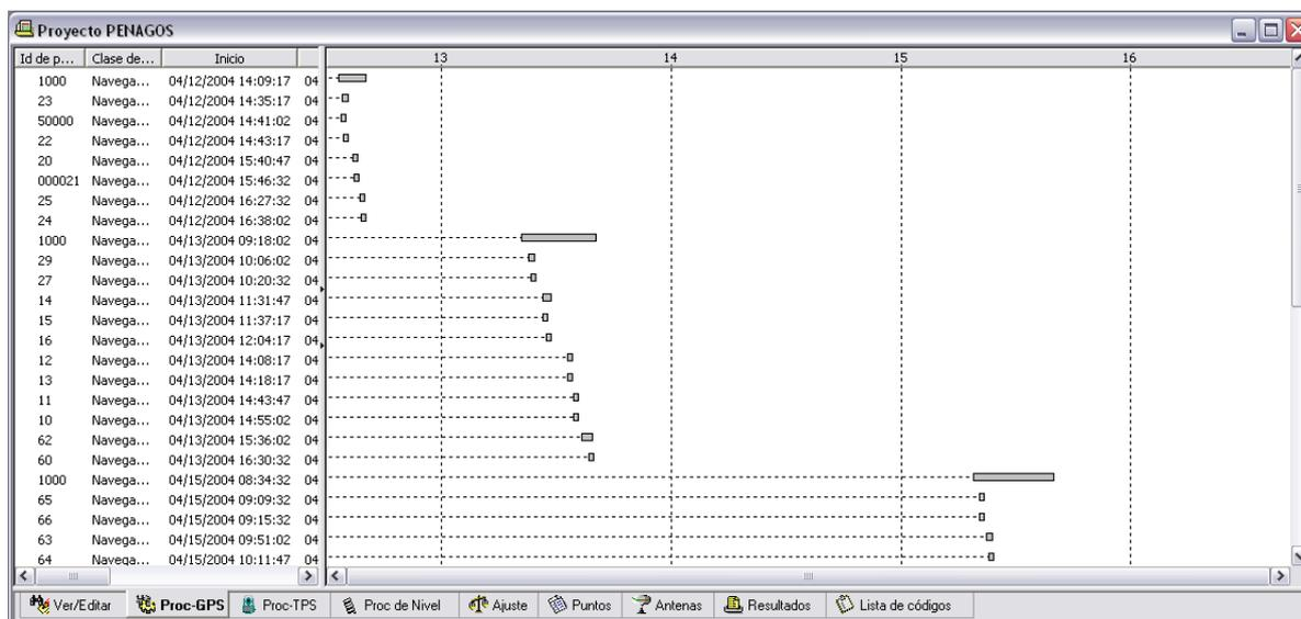
En la ventana de la izquierda se pueden ver los puntos observados en campo y se pueden manipular antes de calcular las líneas base mediante la opción **Propiedades**. También se puede cambiar la altura de la antena en cada punto.
