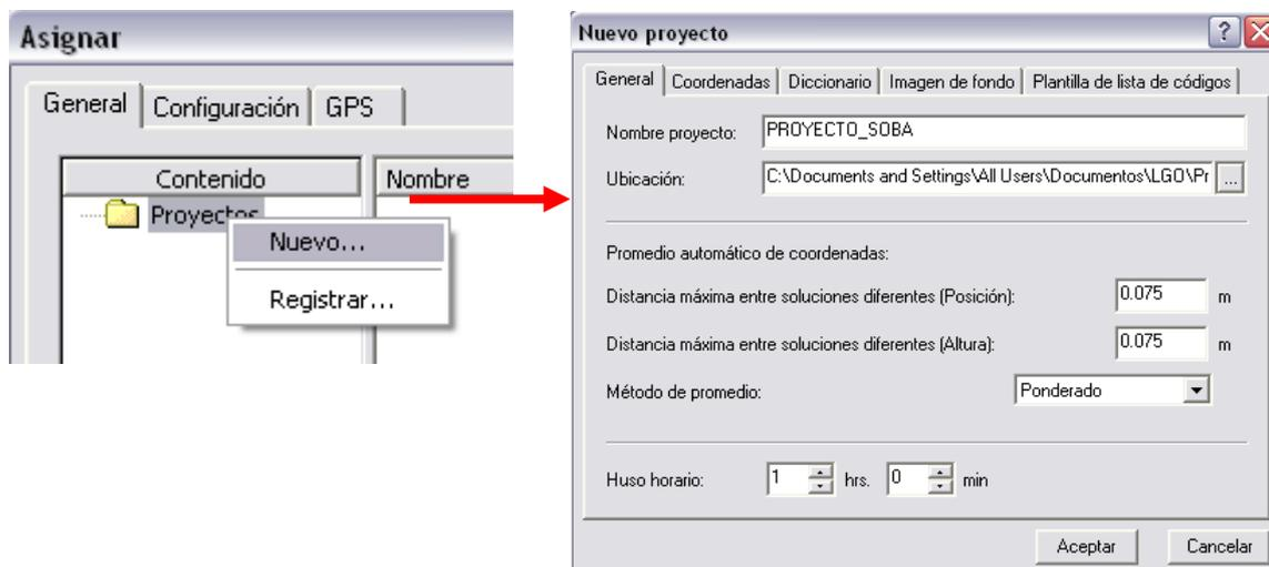
Después de asignar el nombre y la ubicación del proyecto se deberá asignar el sistema de coordenadas en la pestaña **Coordenadas** de tal manera que si se creó el sistema en campo no será necesario asignarlo ya que se asignará automáticamente al proyecto al importar los datos.
