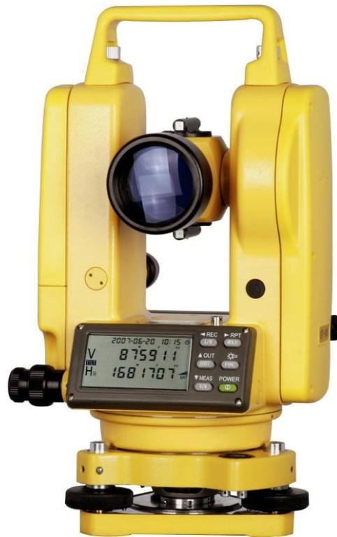
Figura Número 27.- Lecturas angulares de un teodolito electrónico
