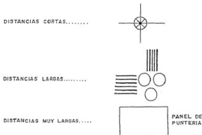
Figura Número 63.- Condicionante de la distancia en el error de puntería
