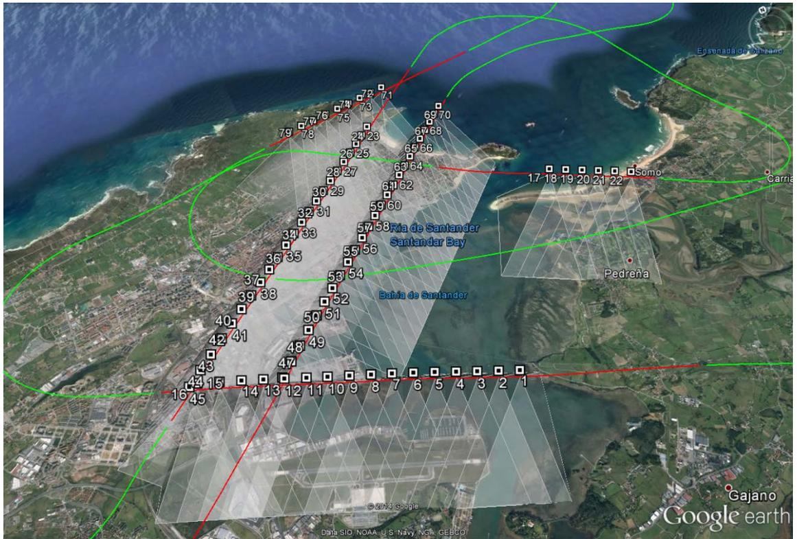
Ilustración 24.- Planificación del vuelo.
