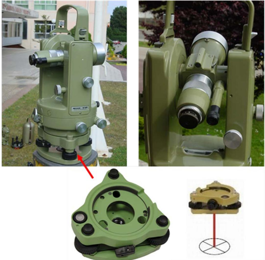
**Figura 6.- Plataforma nivelante.**
