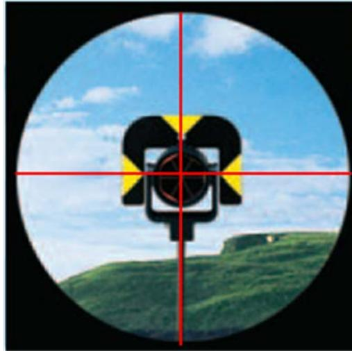
Figura 9.- Puntería sobre un prisma.
