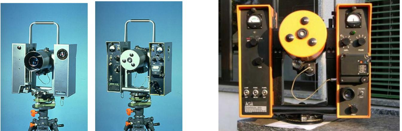
Figura 26.- Geodímetro.
