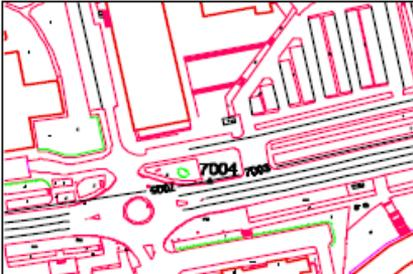
Ilustración 25.- Ejemplo de la reseña de un vértice en una red topográfica municipal (Ayuntamiento Santander).
