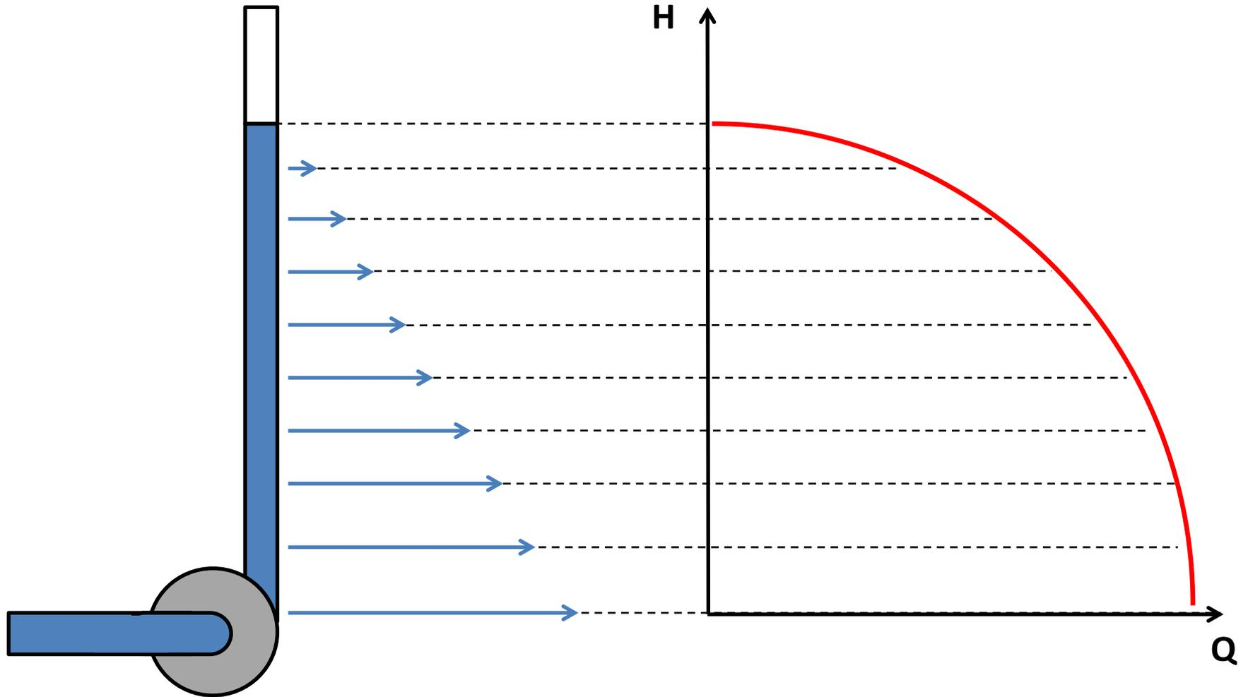
A una determinada velocidad de giro, una bomba centrífuga tiene una curva característica como la siguiente:
