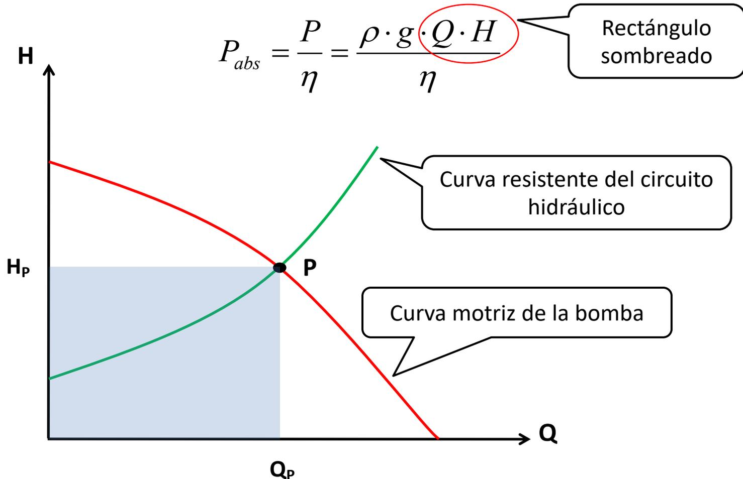
Ejemplo 1: A partir de los datos obtenidos en el ensayo con agua de una bomba centrífuga a 1450 rpm, obtener sus curvas  $H = f(Q)$  y  $\eta = f(Q)$
