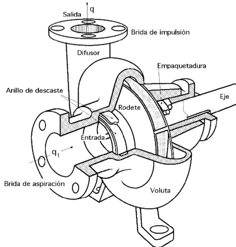
Una bomba es una máquina hidráulica de tipo generador, que absorbe energía mecánica y restituye al líquido energía hidráulica. Se clasifican en dos grandes grupos: Rotodinámicas y volumétricas.
