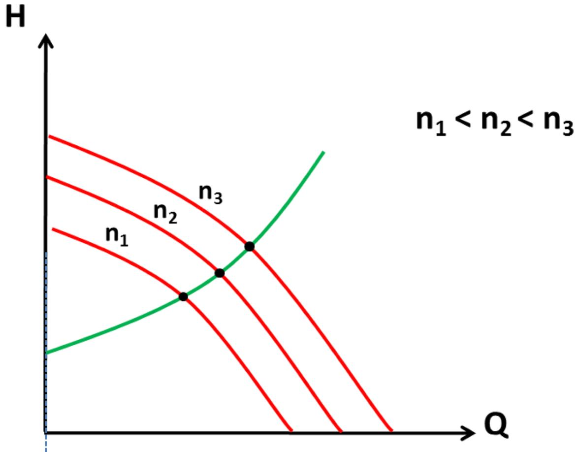
Por lo tanto, el punto de funcionamiento será aquél en el que coinciden la curva característica de la bomba y la curva resistente del circuito.
