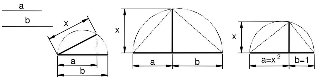
Media proporcional  $x$  a dos segmentos  $a, b$ ;  $x^2=a \cdot b$ ;  $\frac{a}{x} = \frac{x}{b}$  Si  $b=1$ ;  $x=\sqrt{a}$
