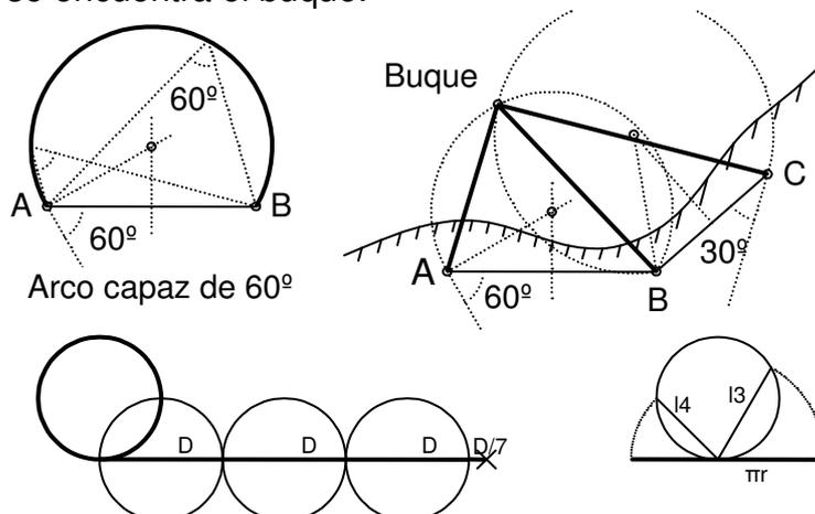
Figura 2: Arco capaz. Problema de Potenot. Rectificación circunferencia.
