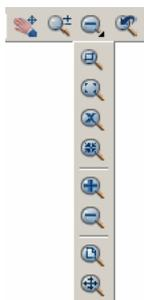
Cuando los dibujos con los que se trabaja cuentan con muchos detalles, es posible ampliarlos para obtener una vista más cercana. Puede cambiar la ampliación de una vista acercando o alejando el zoom. La orden ZOOM no cambia el tamaño absoluto de los objetos en el dibujo; sólo cambia la ampliación de la vista.
