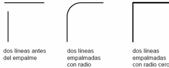
Si establece el radio del empalme en 0, los objetos empalmados se recortarán o alargarán hasta que se crucen, pero no se crearán arcos. Si mantiene pulsada la tecla MAYÚS mientras se designan los objetos se reemplazara el radio de empalme actual con el valor 0.
