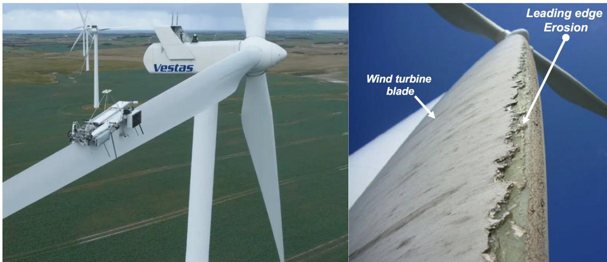
**Figura 42.** Mantenimiento automatizado y ejemplo de defecto (erosión) en una pala. Fuente: [windletter.substack.com/p/welcome-post](http://windletter.substack.com/p/welcome-post).
