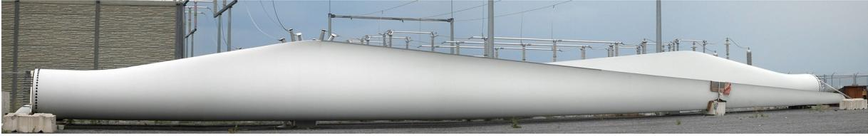
**Figura 38.** Pala Siemens de 49 metros de longitud. Fuente: Wikimedia. Licencia: CC BY-SA 3.0. <http://bit.ly/2DrA646>
