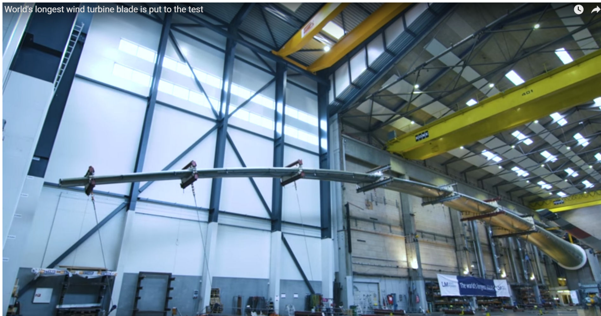
Figura 58. Imagen del ensayo estructural de una pala de aerogenerador de 88.4 metros de longitud. Fuente: LM Wind Power. Fotograma del vídeo YouTube: https://youtu.be/5m-jwwM3qRs
