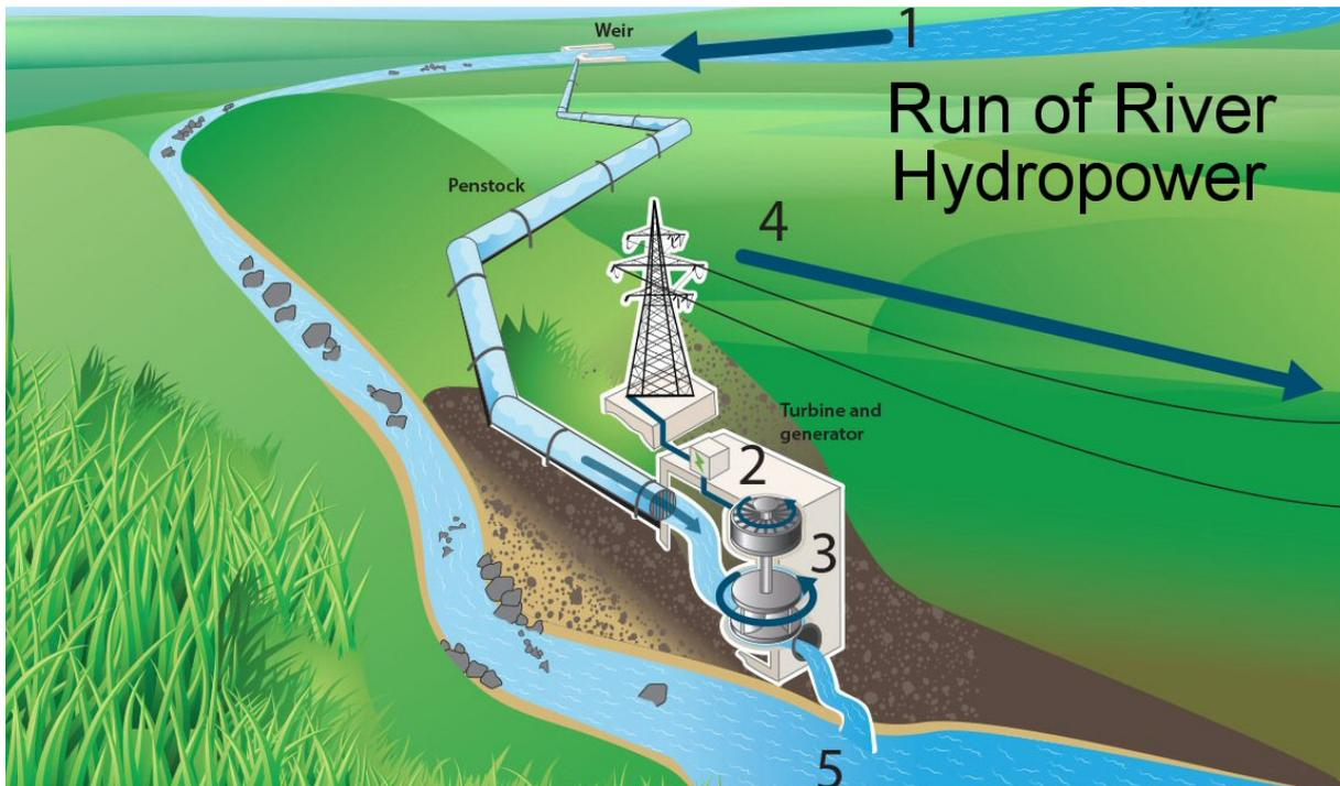
**Figura 6.** Ejemplo de central hidroeléctrica por modificación del cauce de un río. Fuente: <https://bit.ly/1tahjf8>
