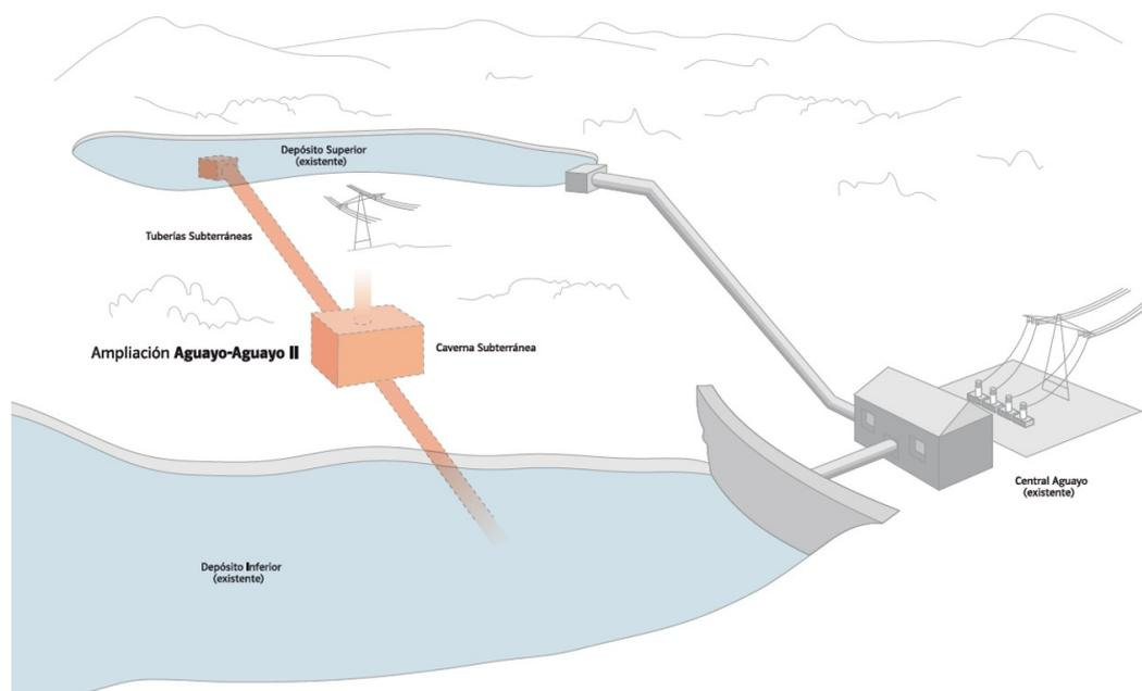
**Figura 7.** Esquema de una central hidroeléctrica de bombeo (Aguayo II). Fuente: EON España (Proyecto de ampliación de la central eléctrica Aguayo II)
