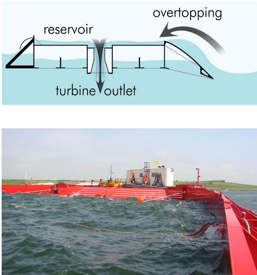
**Figura 22.** Ejemplo de *overtopping device*: a) Esquema de funcionamiento (parte superior); b) Imagen del Wave Dragon (ejemplo de *overtopping device*). Fuente: Erik Friis-Madsen / Licencia: Creative Commons Attribution 3.0 Unported (ambas imágenes).
