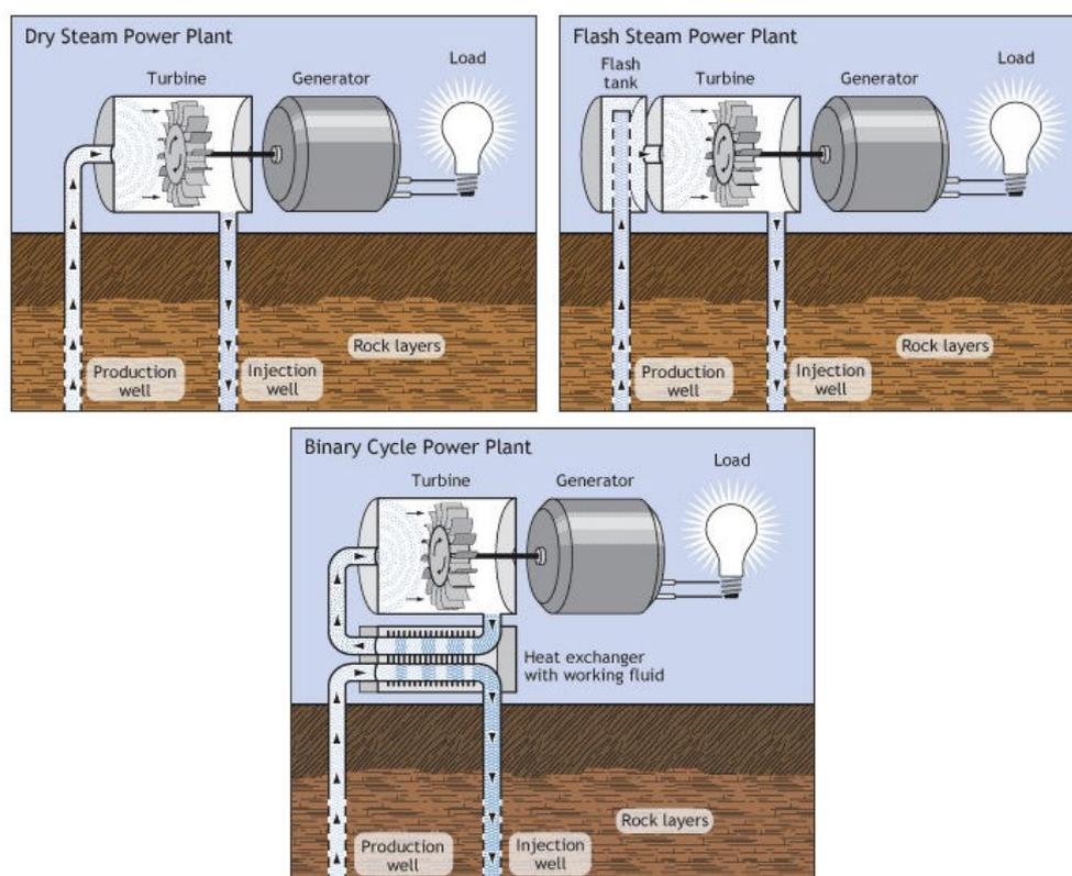
**Figura 31.** Tipologías de centrales geotérmicas. Fuente: <https://bit.ly/1N50wjm>
