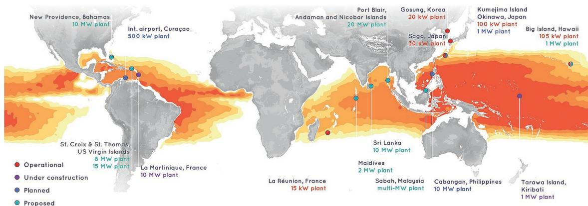
**Figura 24.** Mapa con la distribución de posibles emplazamientos para el aprovechamiento de instalaciones OTEC. Fuente: <http://bit.ly/2DCvTv5>. Licencia CC BY-SA 4.0.
