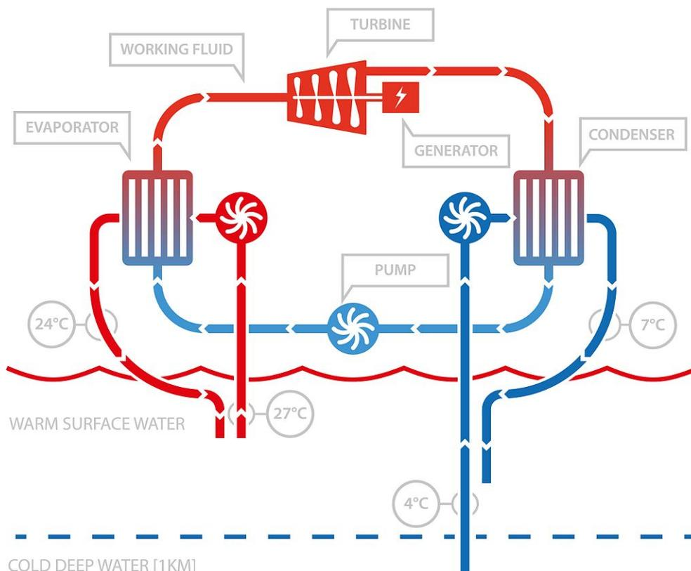
**Figura 25.** Esquema del principio de funcionamiento de un sistema OTEC. Fuente: <http://bit.ly/2DyHDdX>. Licencia CC BY-SA 4.0.
