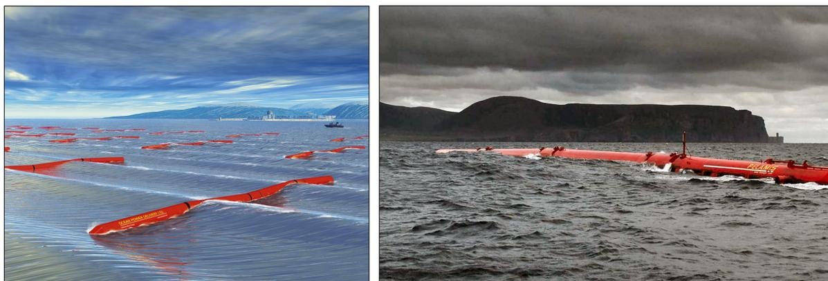
**Figura 21.** Ejemplos de boyas undimotrices de referencia móvil: a) recreación artística de un campo de Pelamis (Fuente: Jumanji Solar (Flickr) <https://bit.ly/2DHM9dE>, b) Sistema Pelamis durante pruebas de campo en el EMEC (European Marine Energy Test Centre) (Fuente: <https://bit.ly/2rDoZjU> (Licencia: dominio público)).
