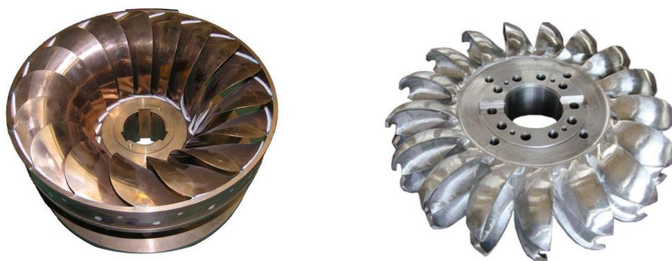
**Figura 8.** Ejemplo de turbinas empleadas en centrales hidroeléctricas. Fuente: (Imagen izquierda: Audrius Meskauskas - Own work / The rotor of the water turbine. Taken in the plant that manufactures the water turbines, Zurich); (Imagen derecha: <https://bit.ly/2E4ilWi>)
