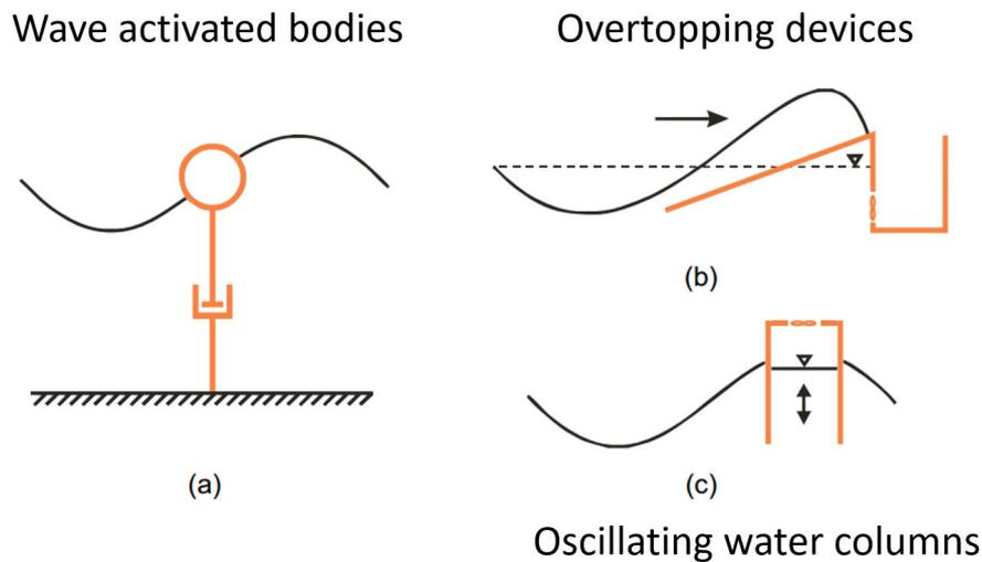
**Figura 19.** Tipos de dispositivos basados en la energía undimotriz: a) *Wave activated bodies*, b) *Overtopping devices* y c) *Oscillating water columns*.
