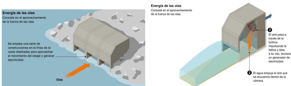
**Figura 23.** Esquema de funcionamiento de una columna de agua oscilante. Fuente: <https://bit.ly/1qsdtw0> (Licencia para usos docentes y formativos.).
