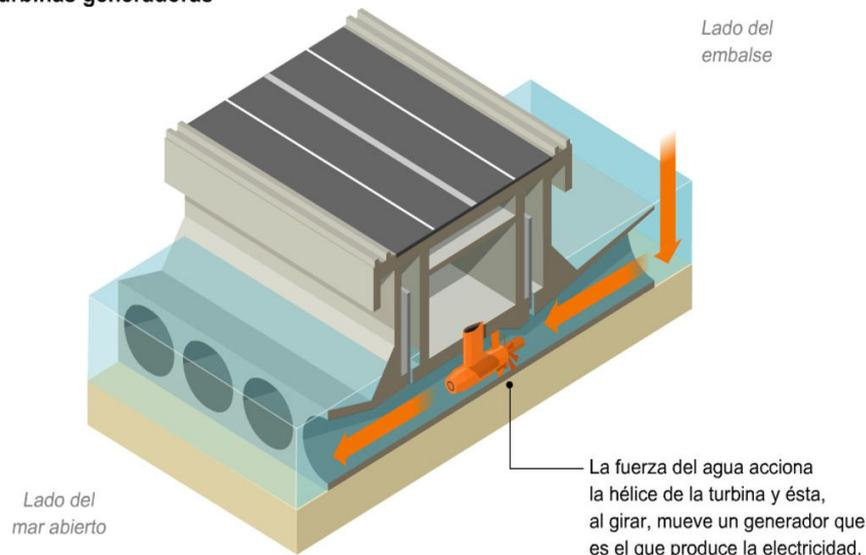
**Figura 12.** Esquema del funcionamiento de una central basada en la energía mareomotriz. Fuente: <https://bit.ly/1qsdtw0> (Licencia para usos docentes y formativos.)
