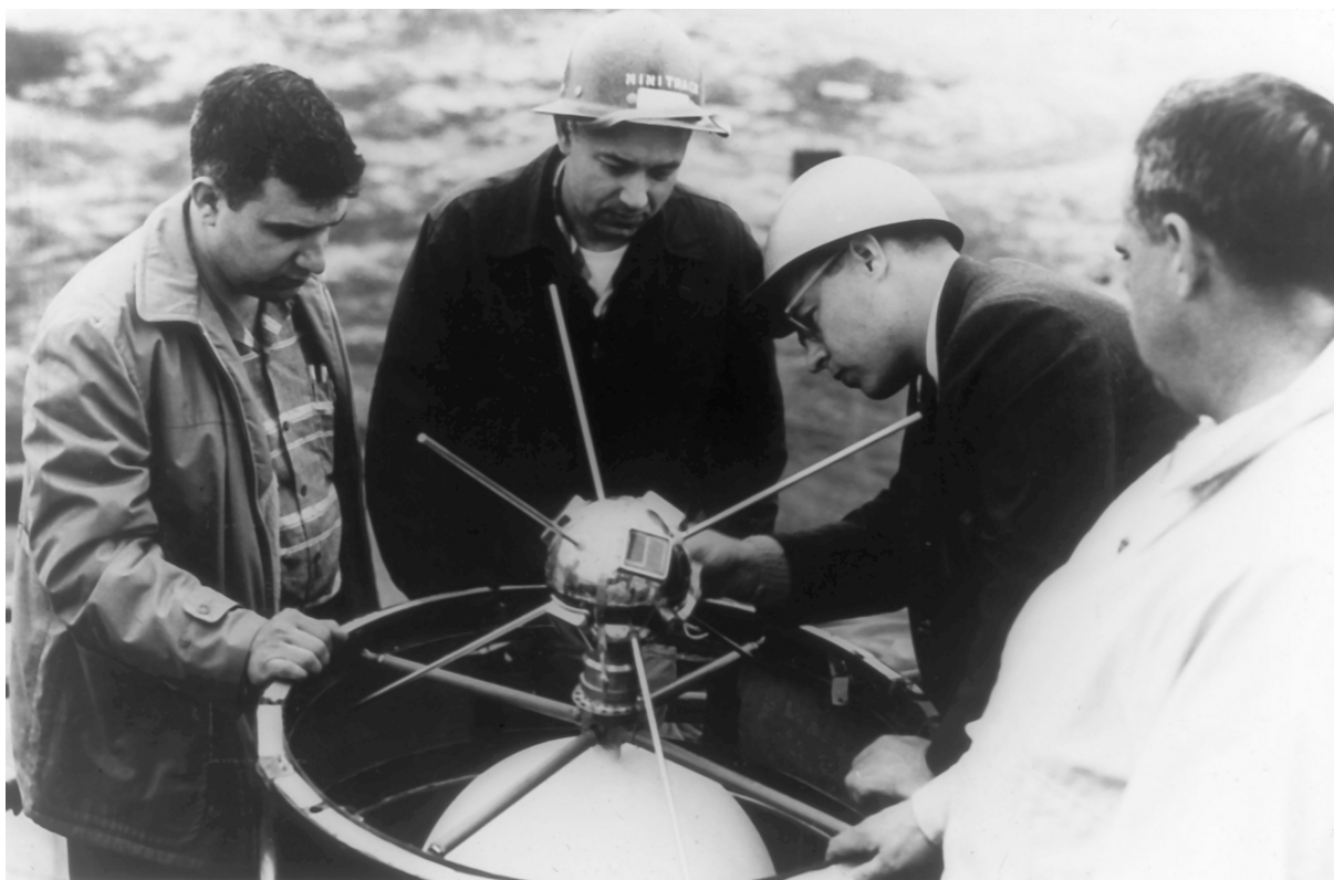
Figura 18. Científicos instalando el satélite Vanguard-I en el cohete de lanzamiento. Fuente: Wikimedia. License: Public Domain http://bit.ly/2DJMvBn
