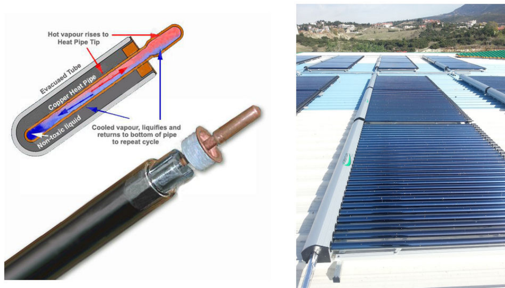
Figura 9. Esquema del funcionamiento de un tubo de vacío (izquierda). Ejemplo de sistema solar térmico basado en tubos de vacío. Fuente (izquierda): http://bit.ly/2kUyt3x (Dominio Público). Fuente (derecha): Greensolarvacuum (Licencia CC BY-SA 3.0) http://bit.ly/2kW0Gqv .
