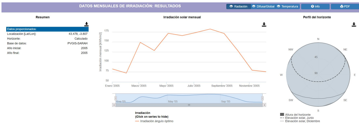
Figura 113. Herramienta Solar Radiation Tool de PVGIS: muestra de datos de radiación mensual para Santander. Fuente: PVGIS. Enlace: https://bit.ly/3n4Tqsk
