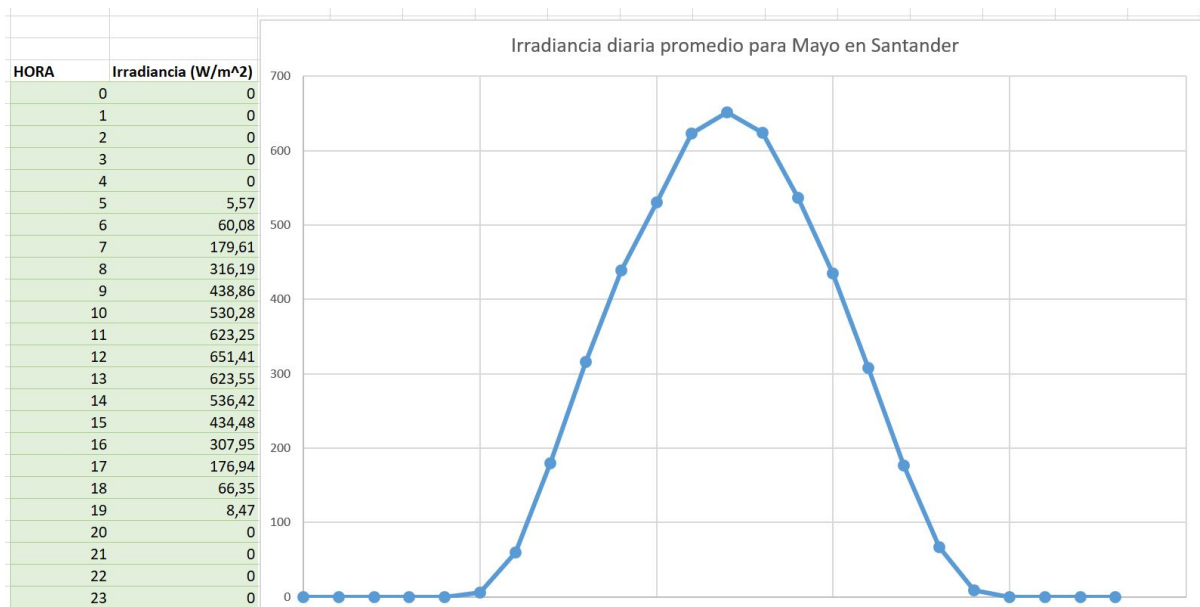
Figura 115. Irradiancia para un día promedio de Mayo en Santander. Fuente: PVGIS. Enlace: https://bit.ly/3n4Tqsk
