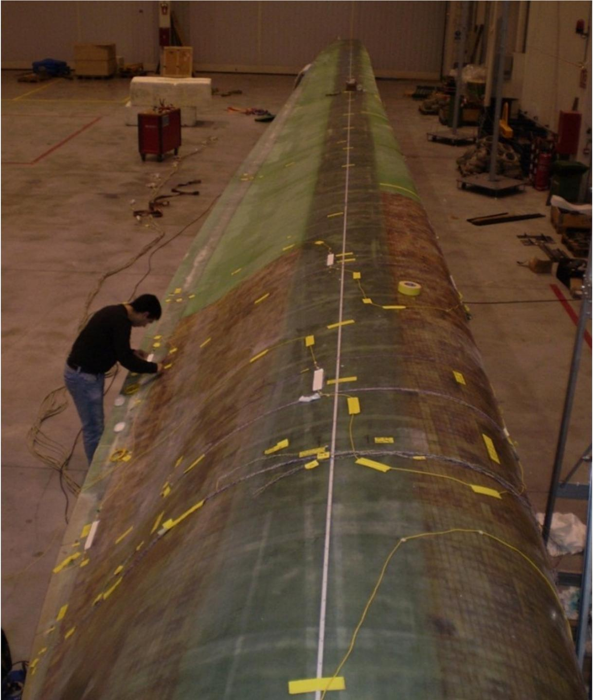
**Figura 1.59.** Imagen de la instalación de un sensor de fibra óptica en la pala de un aerogenerador. Fuente: Grupo de Ingeniería Fotónica de la Universidad de Cantabria
