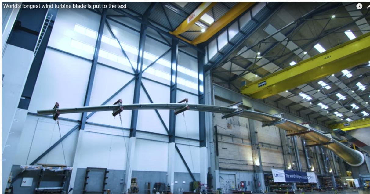
**Figura 1.57.** Imagen del ensayo estructural de una pala de aerogenerador de 88.4 metros de longitud. Fuente: LM Wind Power. Fotograma del vídeo YouTube: <https://youtu.be/5m-jwwM3qRs>
