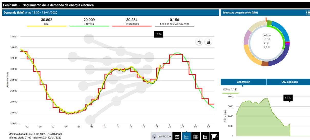
**Figura 1.45.** Ejemplo de información en tiempo real sobre demanda y generación en el sistema eléctrica español: 12 Enero, 2020). Fuente: REE.
