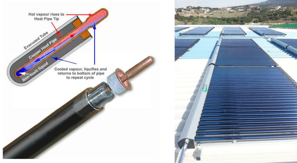
Figura 2.8. Esquema del funcionamiento de un tubo de vacío (izquierda). Ejemplo de sistema solar térmico basado en tubos de vacío. Fuente (izquierda): http://bit.ly/2kUyt3x (Dominio Público). Fuente (derecha): Greensolarvacuum (Licencia CC BY-SA 3.0) http://bit.ly/2kW0Gqv .
