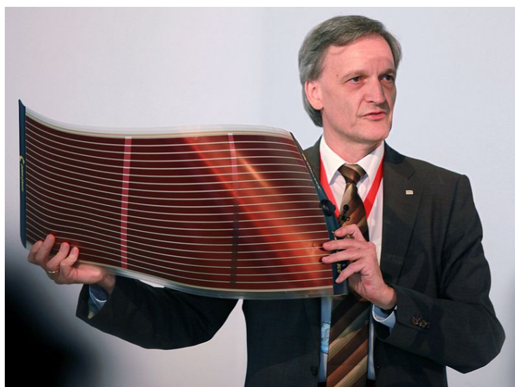
Figura 2.60. Ejemplo de tecnología fotovoltaica basada en células orgánicas. Fuente: https://bit.ly/2ASKYX0 . Licencia: CC BY-SA 3.0
