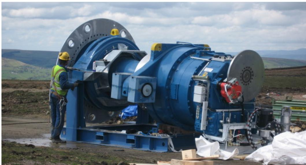
**Figura 3.41.** Detalle del ensamblado del sistema de frenado (y caja multiplicadora) de un aerogenerador modelo Nordex N80 (altura de torre: 60 m; longitud de pala: 40 m). Fuente: Paul Anderson (CC BY-SA 2.0). <http://bit.ly/2ES1HbK>
