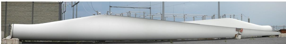
**Figura 3.31.** Pala Siemens de 49 metros de longitud. Fuente: Wikimedia. Licencia: CC BY-SA 3.0. <http://bit.ly/2DrA646>
