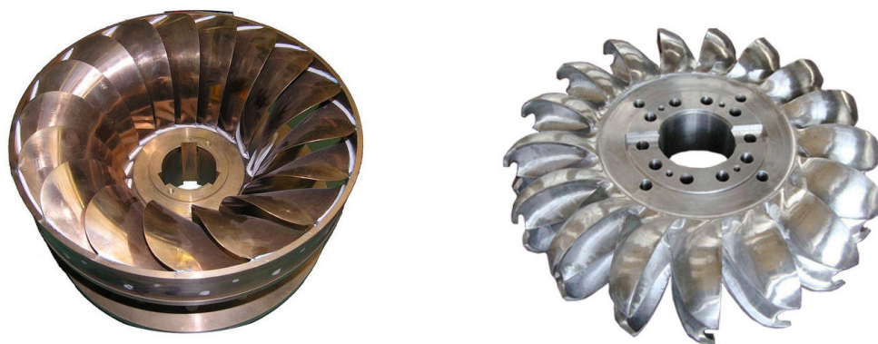
Figura 4.7. Ejemplo de turbinas empleadas en centrales hidroeléctricas. Fuente: (Imagen izquierda: Audrius Meskauskas - Own work / The rotor of the water turbine. Taken in the plant that manufactures the water turbines, Zurich); (Imagen derecha: https://bit.ly/2E4i1Wi )
