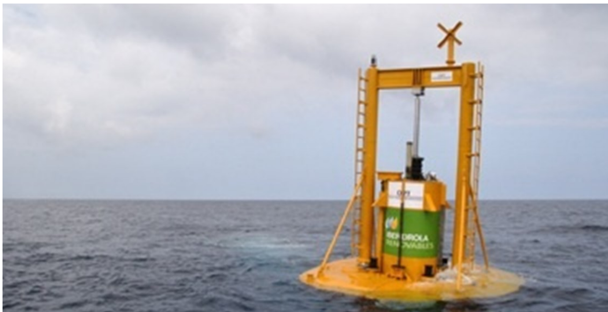
Figura 4.18. Ejemplo de boya undimotriz experimental instalada en Santoña. Fuente: Europapress http://bit.ly/2DBFuhC
