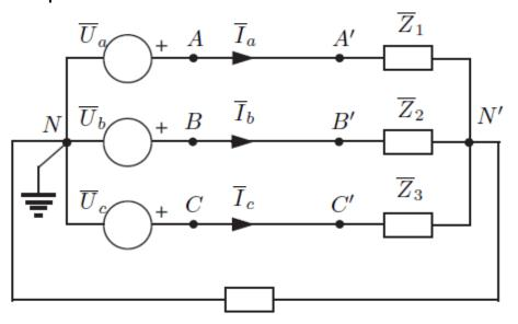
Como puede observarse, se ha considerado para el análisis que el conductor del neutro presenta una impedancia  $\overline{Z}_N$ . La impedancia de los conductores de fase puede ser asociada a las cargas de cada una de dichas fases.
