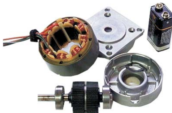
Figura 3.37. Despiece de un motor paso a paso bipolar.
