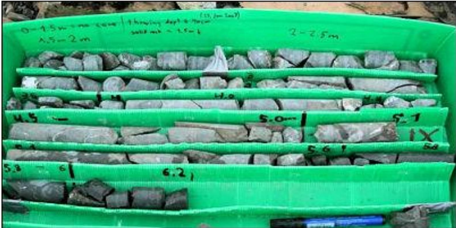
$$RQD = \frac{\sum \text{longitud de los trozos de testigo} > 10\text{cm}}{\text{longitud total del tramo}} \times 100$$
