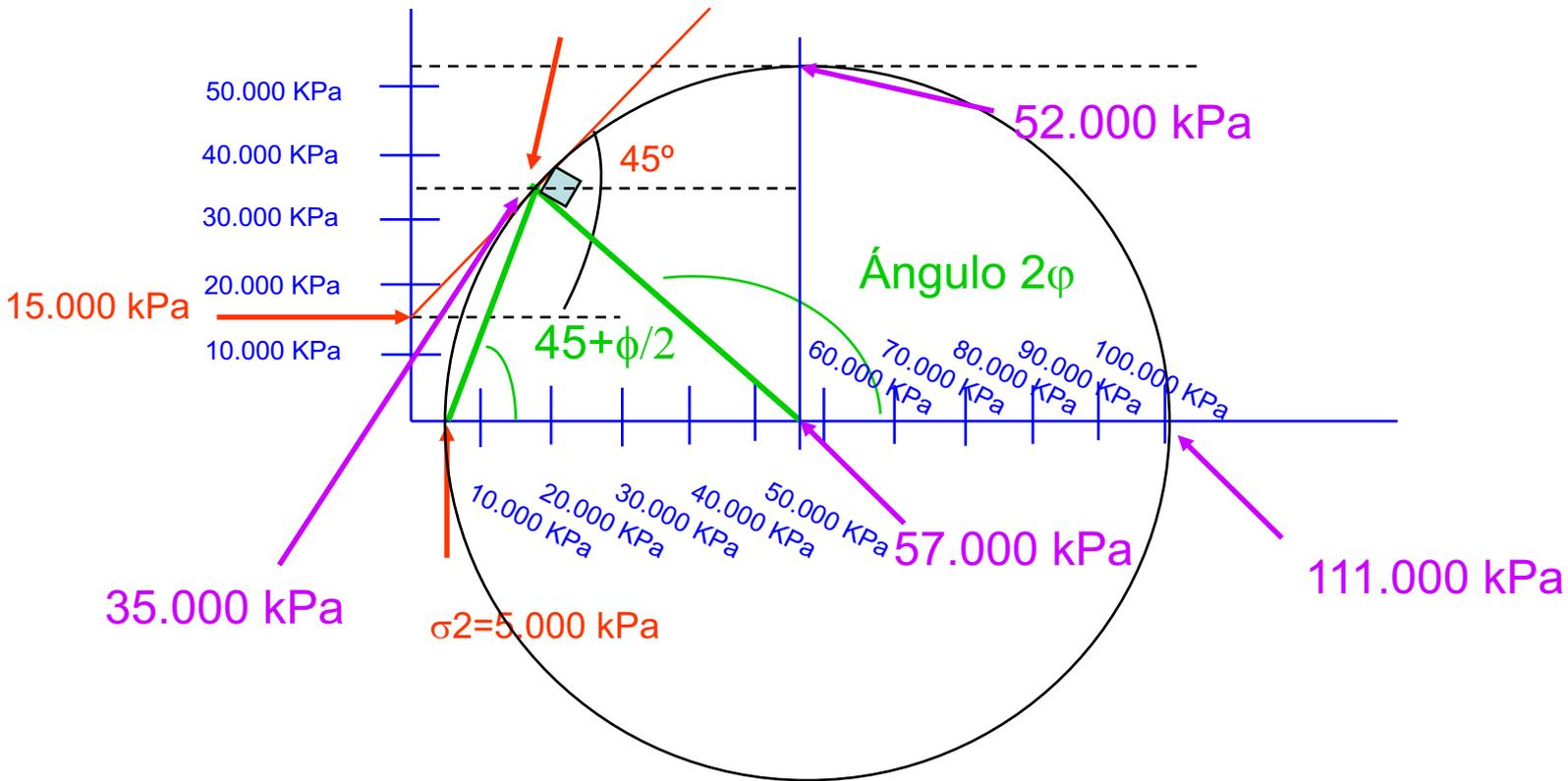
Ahora con un compás, con centro en 57.000kPa y radio en  $\sigma_2$  trazamos  $\sigma_1 = 111.000 \text{ kPa}$ ; la mayor resistencia al cizallamiento la dará el punto de tangencia entre círculo y línea 35.000 Kpa
