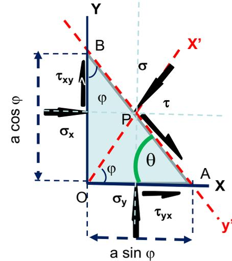
Realizamos un esquema de la representación de Mohr para recordar la posición del ángulo  $\theta$  y  $2\theta$
