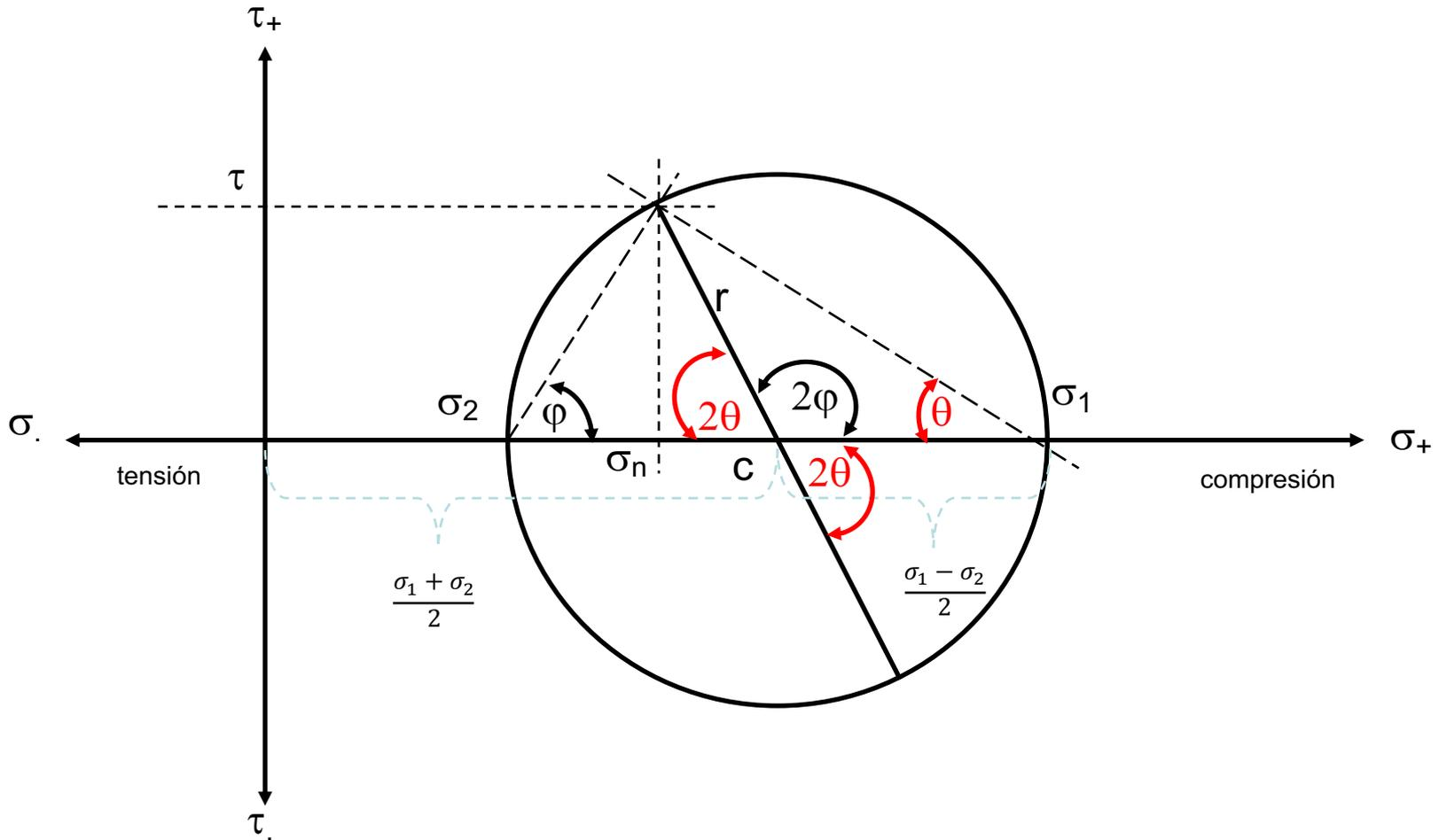
Pintamos el cilindro y colocamos los esfuerzos principales. En la posición de los esfuerzos principales no existen esfuerzos tangenciales ( $\tau=0$ ). Calculamos el centro y radio del círculo. A continuación calculamos el esfuerzo medio (centro) y el radio.
