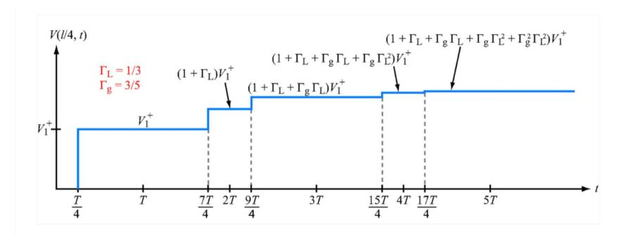
Ejemplo 10: El circuito de la figura se excita con un pulso de tensión rectangular de amplitud 5 V y anchura 1 ns. Calcular la forma de la onda de la tensión en los terminales de la carga sabiendo que la línea de transmisión tiene 0.6 m de longitud y la velocidad de fase es c.
