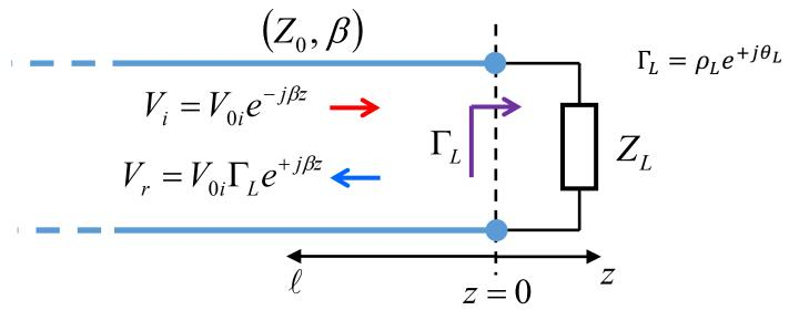
La tensión total en la línea es el resultado de la interferencia (suma) de la onda incidente con la reflejada:
