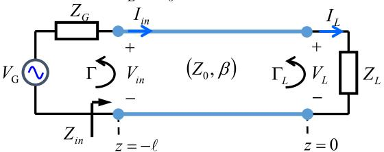
• 2. Impedancia de entrada adaptada al generador  $Z_{in} = Z_G$ :
