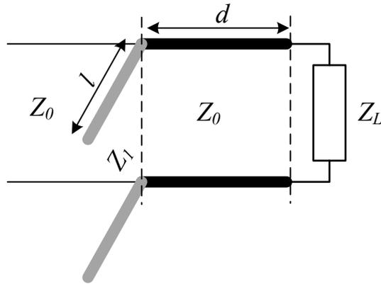
4. Si se sustituyen los stubs calculados anteriormente por elementos reactivos en paralelo, calcular los valores de dichos elementos reactivos. **(1 punto)**
