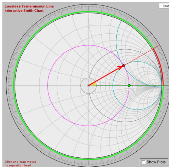
El desplazamiento realizado es  $d = 0.04156\lambda$ , que equivale a  $d = 12.47 \text{ mm}$ .
