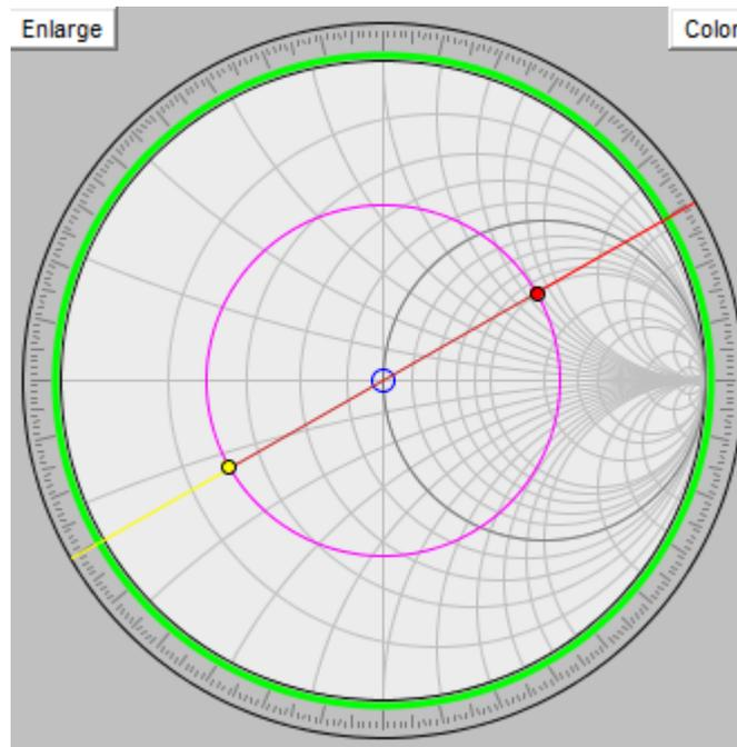
Ahora, para la primera solución, desplazamos esta admitancia de carga, en dirección al generador, hasta cortar el círculo de  $\text{Re}(Z) = 1$  constante, círculo unitario.
