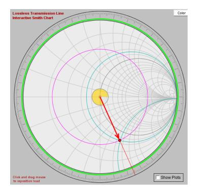
Llevamos el radio del círculo a la escala inferior correspondiente al coeficiente de reflexión (RFL. COEFF. E or I) y leemos el valor aproximado del módulo de dicho coeficiente:  $|\Gamma_L|$  = 0.62. A continuación, miramos la fase del coeficiente en la escala exterior correspondiente (ANGLE OF REFLECTION COEFFICIENT IN DEGREES), resultando un valor  $\theta$  = -65° aprox. Por tanto, se tiene:
