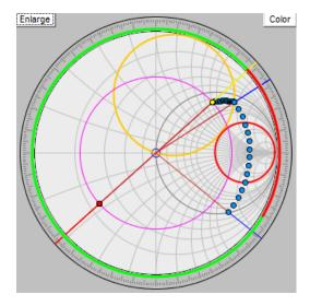
El punto al que se llega es  $\bar{Y}_b=1-j2.47$ . Como es lógico, el nuevo punto se encuentra sobre el círculo de radio R = 1. Finalmente, con el segundo stub se realiza el desplazamiento de este punto hasta el centro de la Carta de Smith sobre el círculo de parte real constante.
