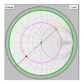
A continuación, dibujamos el círculo de valor constante R = 1 girado una distancia d = 10 mm =  $0.1\lambda$  en dirección a la carga (círculo amarillo). Este círculo nos permite ver qué zona de la Carta no es adaptable con esta configuración (interior del círculo rojo). Dado que nuestra admitancia está fuera de esta zona prohibida no habrá ningún problema.
