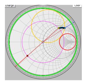
En este movimiento partimos de (punto amarillo)  $\overline{Y}_{in}=1.32+j1.83$  y llegamos a (punto azul)  $\overline{Y}_a=1.32+j2.82$ . Por lo tanto, la susceptancia que introduce el primer stub es  $\overline{B}_1=0.99$ . Como se nos dice que es un stub en cortocircuito, calculamos su longitud mediante la siguiente ecuación dada en el enunciado.
