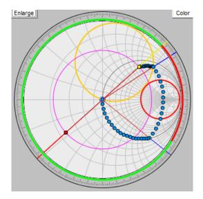
Por tanto, la susceptancia de este segundo stub será:  $\bar{B}_2=2.47$ . Dado que se nos dice que es un stub en circuito abierto, su longitud se calcula con la siguiente ecuación:
