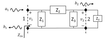
El parámetro S<sub>11</sub> representa el coeficiente de reflexión de entrada y se ha visto en clase que se puede calcular mediante la siguiente ecuación:
