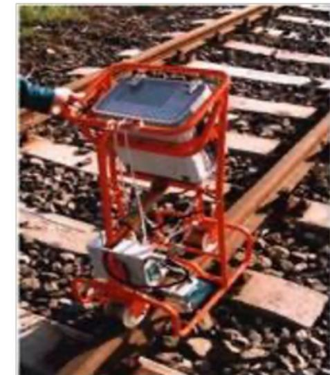
Medidor de temperatura libre de esfuerzo
