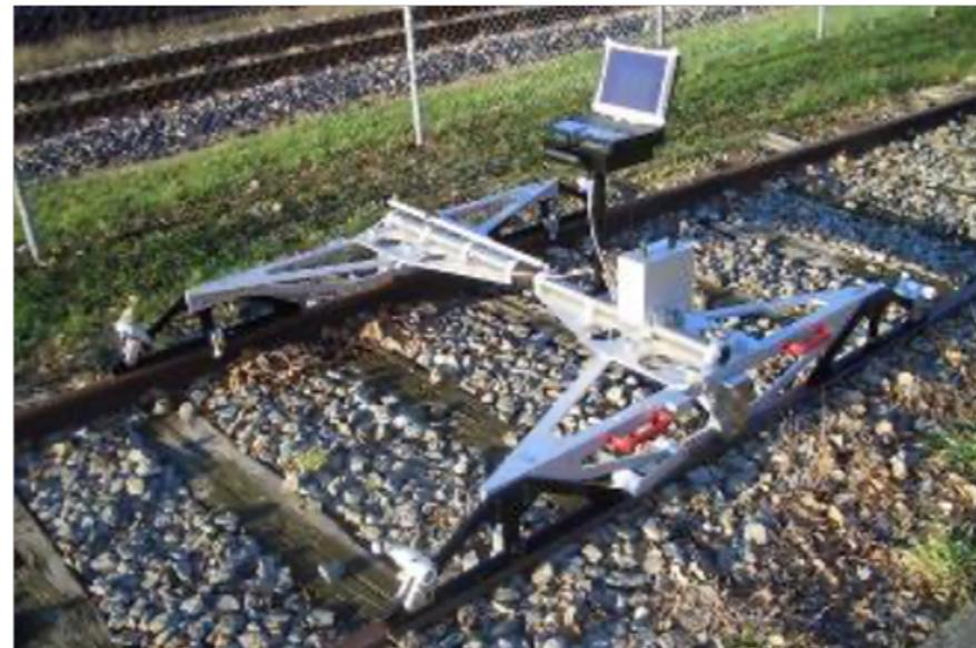
Medidor de desgaste ondulatorio
