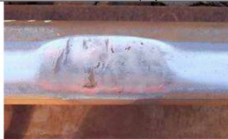
010501 Aplastamiento de la superficie de rodadura leve [10]
