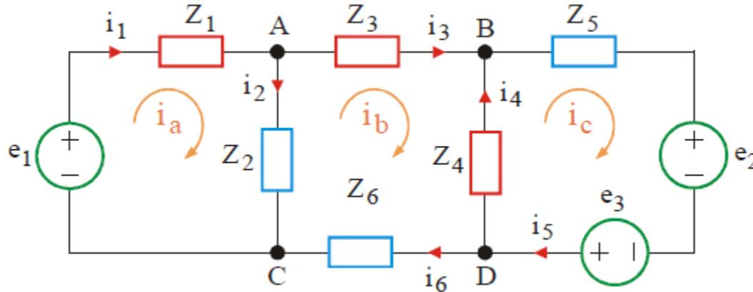
$$\begin{cases} e_1 - Z_1 i_a - Z_2(i_a - i_b) = 0 \\ -Z_3 i_b - Z_4(i_b - i_c) - Z_6 i_b - Z_2(i_b - i_a) = 0 \\ -Z_5 i_c - e_2 + e_3 - Z_4(i_c - i_b) = 0 \end{cases}$$
