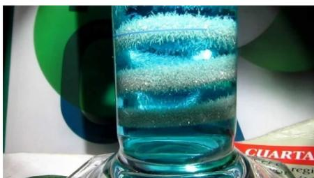
**Figura 7.1.** Barra de cobre sumergida en una disolución de AgNO<sub>3</sub>.
