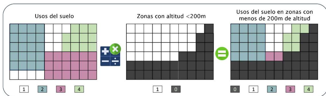
Figura 2. Ejemplo de esquema de funcionamiento del álgebra de mapas al multiplicar una capa binaria (0|1) por otra que no lo es
